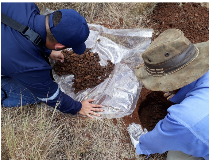
Figura 3. Toma de muestras de suelo residual para su análisis, para evaluación de minerales presentes, en la etapa de prospección de un proyecto minero, al sur del estado Bolívar, Venezuela. Fuente: Archivo https://timna.ch/
