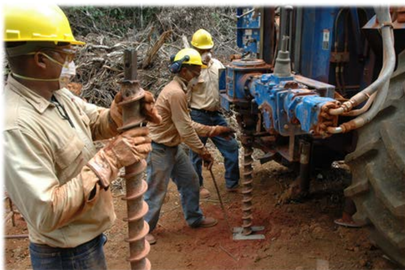
Figura 2. Para garantizar los recursos mineros, son necesarias las campañas de exploración, tanto para encontrar nuevos prospectos como para mantener la vida útil de las minas existentes. En este caso, exploración geológica por medio de perforación Auger Drill, en la mina de bauxita de Los Pijiguaos, municipio Cedeño del estado Bolívar, Venezuela. Fuente: Williams León, 2005.
