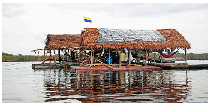
Balsa minera con la bandera de Colombia preparada para extraer los sedimentos del fondo del río Atabapo e inmediatamente derramarlos por una rampa con obstáculos llamado Tame, donde el polvo de oro queda adherido a una cobija que lo cubre. (Foto Charles Brewer-Carias 2014)
